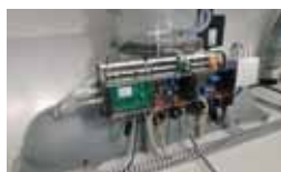
3 Polmone di aspirazione con dispositivo di regolazione, sistema di misurazione e rilevamento posizione
